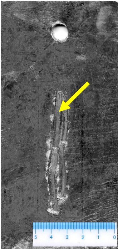
きずの例 めっき作業中、めっき用具とめっき表面とが接触した痕跡。
