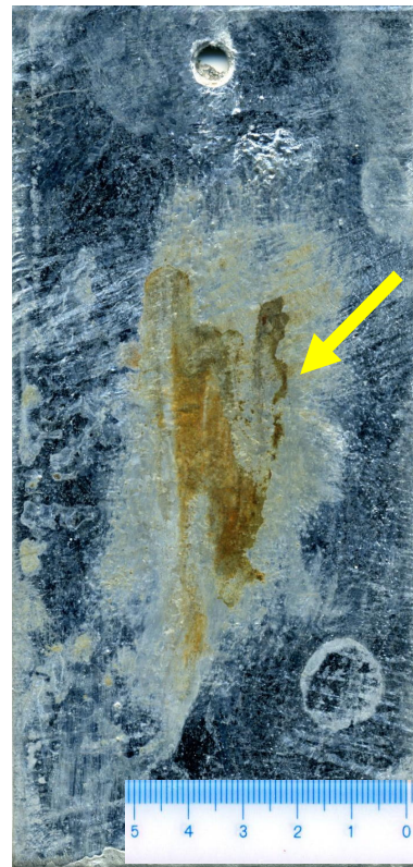
薬品による変色の例 めっき表面が変色したもの。
