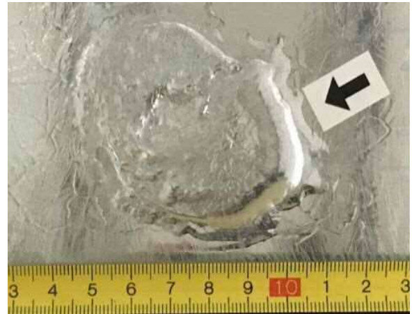
たれの例 素材の表面又は端部に、亜鉛が多量に付着した状態。
