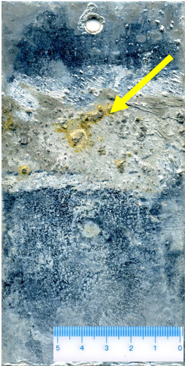
かすびきの例 めっき皮膜の表面に亜鉛酸化物又はフラックス残さが付着した状態。
