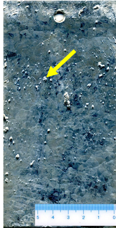
ざらつきの例 めっき表面に凹凸があるもの。
