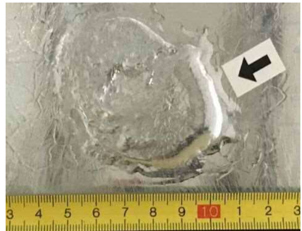
たれの例 素材の表面又は端部に、亜鉛が多量に付着した状態。
