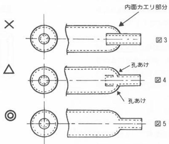
図4のように孔をあけるか、できるだけ図5のように、カエリ部分をなくすような構造にしてください。
